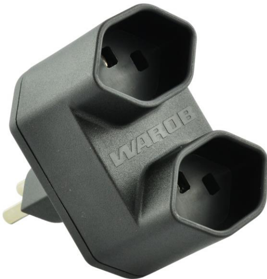
Zweifachstecker Typ 23 WAROB , L+N+PE 16A 250V, Polyamid, halogenfrei, schlagfest, für Steckdose Typ 23/25, für Stecker Typ 11/12/23/26
